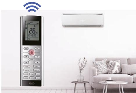
Der in der Fernbedienung eingebaute Sensor misst die Temperatur in der unmittelbaren Umgebung und überträgt ein entsprechendes Signal an das Innengerät. Dadurch kann das Innengerät das Volumen und die Temperatur des Luftstroms entsprechend regeln, um maximalen Komfort genau dort zu gewährleisten wo sich die Fernbedienung befindet, und nicht dort, wo das Gerät installiert ist.
