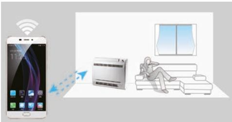
Dank des integrierten WLAN-Moduls kann der Betrieb des Geräts aus der Ferne über die APP auf dem Smartphone gesteuert werden: Ein- oder Ausschalten des Geräts, Auswahl des gewünschten Modus und der gewünschten Temperatur usw., um den Komfort jederzeit zu programmieren, auch wenn man außer Haus ist.
