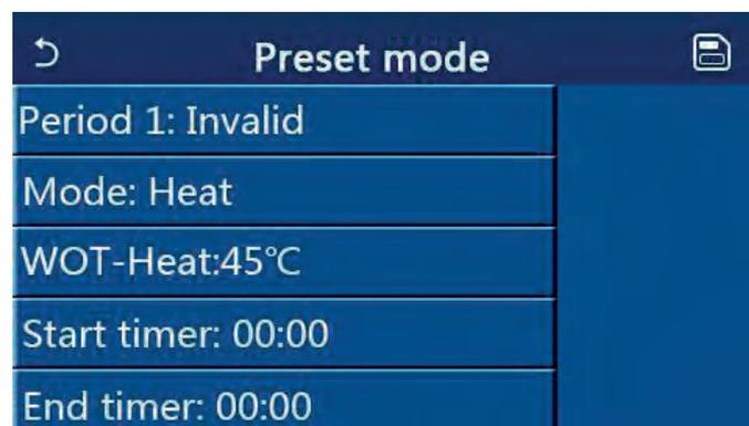
Mit der Option „Modus“ wird der Modus voreingestellt. „WOT-Heat“ wird verwendet, um die Kalt-/Warmwasseraustrittstemperatur einzustellen. „Timer starten“ / „Timer beenden“ dient zur Zeiteinstellung. Danach werden durch Berühren des Symbols „Speichern“ alle Einstellungen gesichert.
