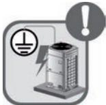
Stellen Sie sicher, dass das Gerät ordnungsgemäß und einwandfrei geerdet werden kann, um einen Stromschlag zu vermeiden. Schließen Sie das Erdungskabel nicht an Gasleitungen, Wasserleitungen, Blitzableiter oder Telefonleitungen an.
