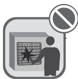
Befestigen Sie das Schutzgitter nicht an der Kondensatleitung.
