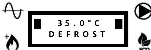
Die erste Zeile zeigt die Rücklaufwassertemperatur an.
